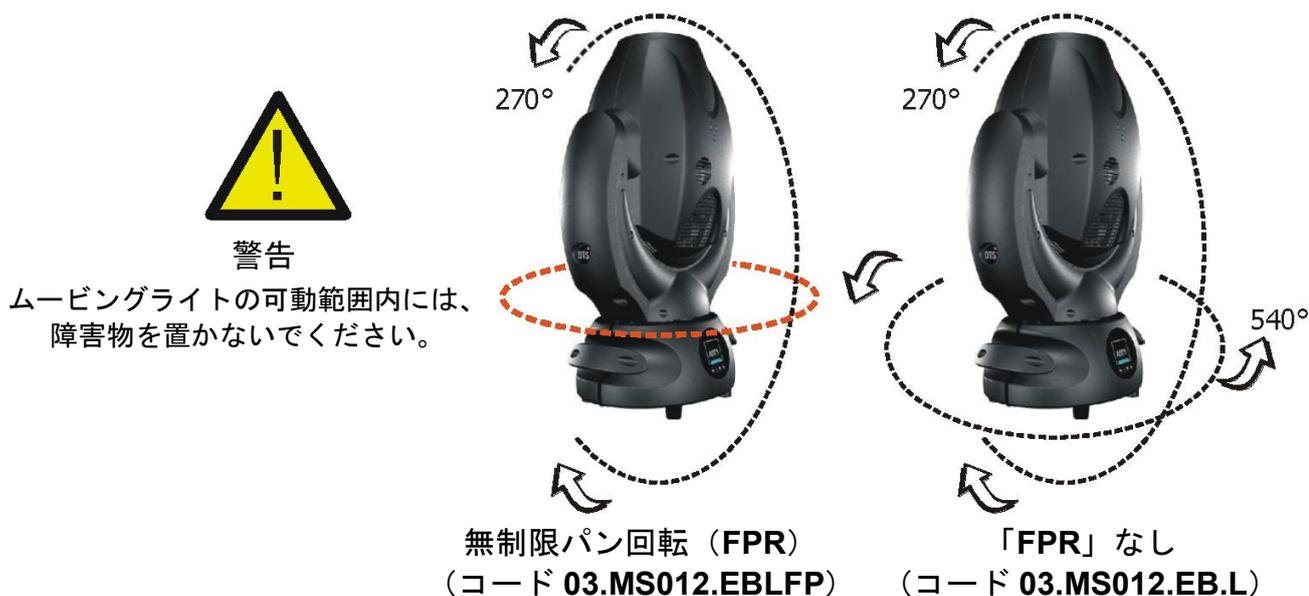
注：DMX コントローラを使用して 2 種類の JACK モデル（FPR あり・FPR なし）を同時に制御する場合には、チャンネル 6（パン FAR）の設定値が 0 になっていることを確認してください。
